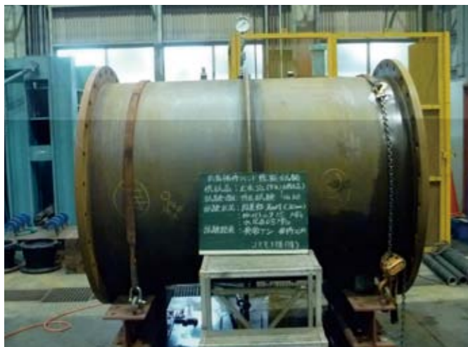
間隙試験 段差 30mm 試験水圧 0.05MPa
