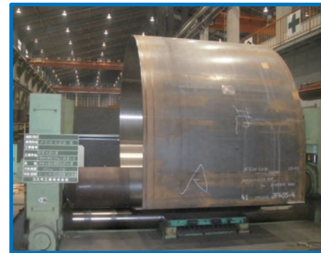
鋼製異形管φ3000mm 鉄板曲げ加工
