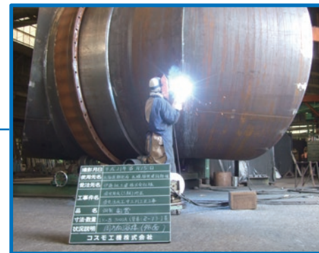
鋼製異形管φ3000mm 溶接作業
