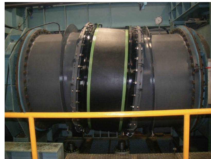
伸縮可撓管 彗星 中圧用 \phi 2000 -100H 偏心試験
