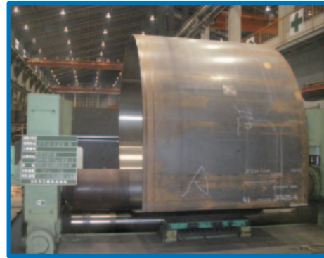
鋼板製異形管φ3000mm 鉄板曲げ加工
