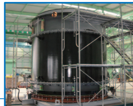
伸縮可撓管φ3500 耐圧検査
