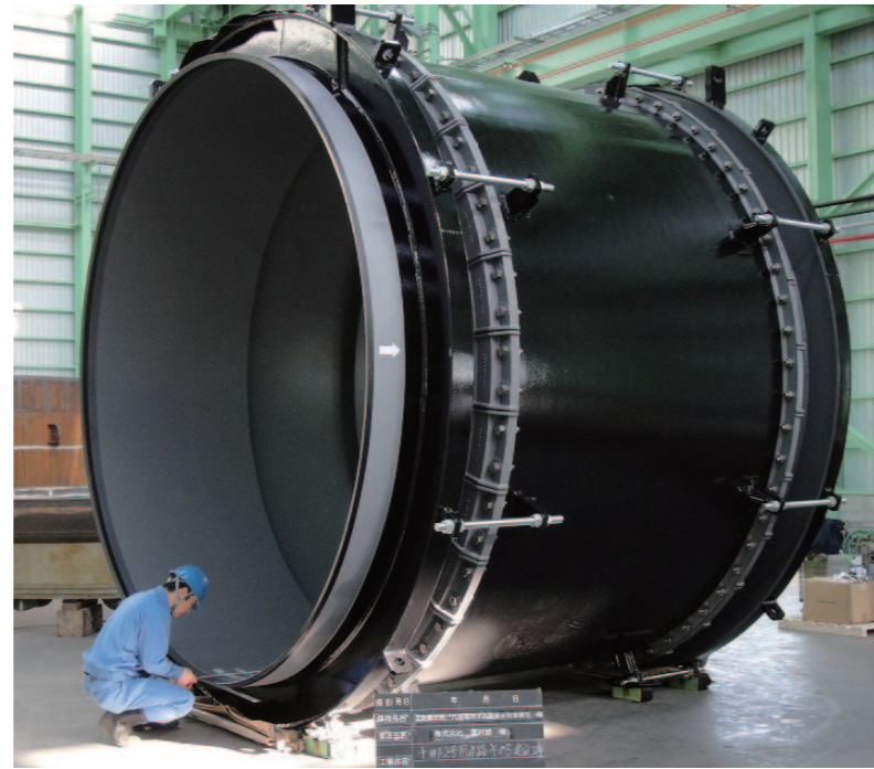
伸縮可撓管 彗星 低圧用 φ3500mm 寸法検査
