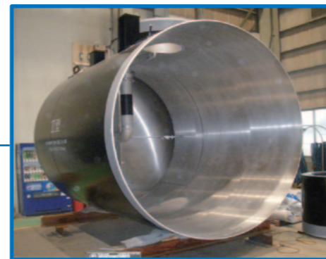
飲料水兼用耐震性貯水槽100t 完成・出荷
