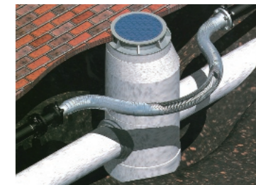
キリマワシフレキ KFJ 地下の障害物を気にする必要がない、 フレキシブル継手を使った切り直し工法です。
