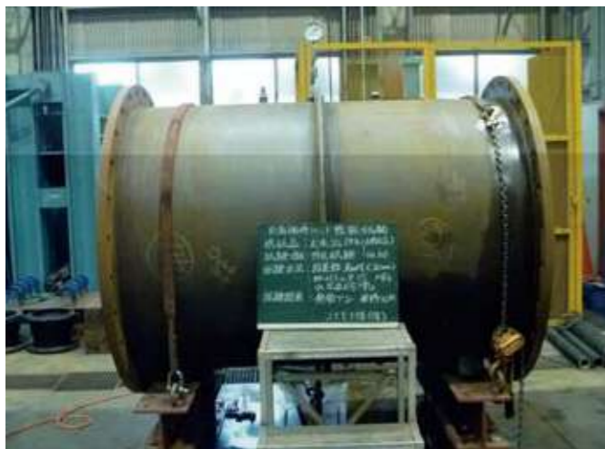
間隙試験 段差 30mm 試験水圧 0.05MPa
