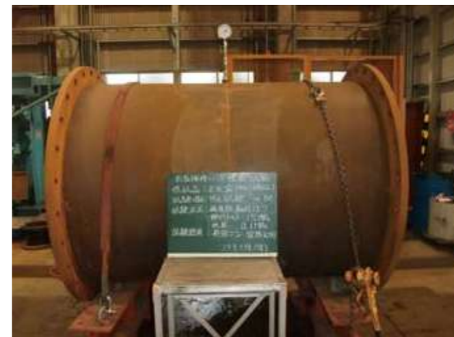
偏角試験 偏角 5 試験水圧 0.05MPa
