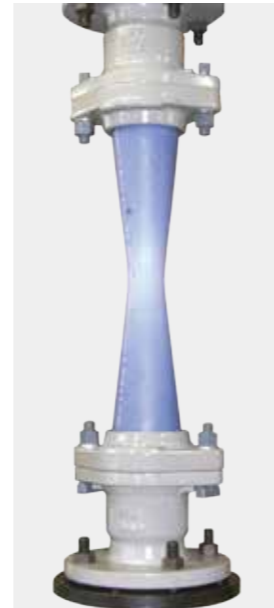
引抜阻止性能試験 (Pメカフランジφ75使用)
