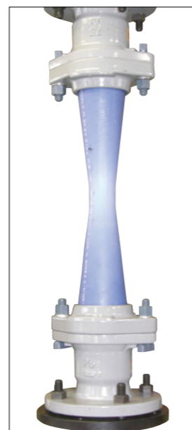
引抜阻止性試験 (Pメカフランジφ75使用)
