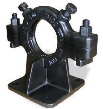
ダクタイル鋳鉄管用 スラスト受金具 KUDT 呼び径/75~400 水平置き、壁取付け、天井取付けなどの鋳鉄管露出配管に 用いる移動防止付き受け金具です。 ※呼び径500は鋼板製にて対応可能です。 ※呼び径600以上はお問い合わせください。
