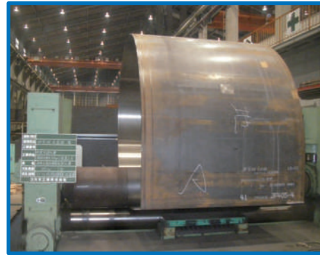
鋼製異形管φ3000mm 鉄板曲げ加工
