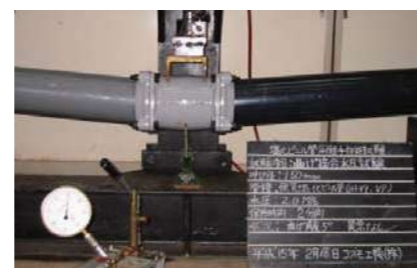
曲げ接合水圧試験
