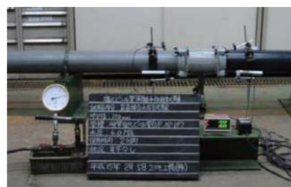
真直接合水圧試験(塩ビ管)
