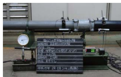
真直接合水圧試験(塩ビ管)
